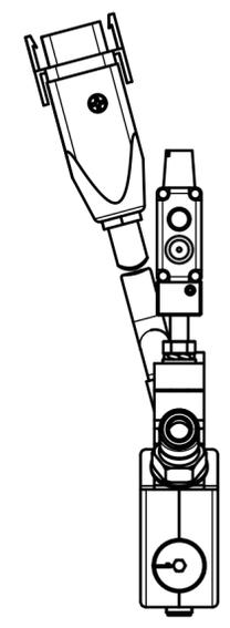
Dem Auftragskopf liegt ein zweites Oberteil des Kopfhalter bei. Je nach Kombination können 10-13mm Sechskant oder 10-13mm Rundprofile zur Kopfbefestigung verwendet werden!
