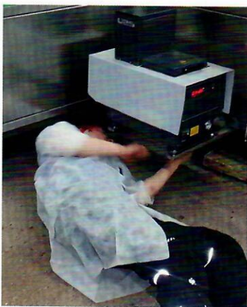
Heißleimgeräte sollten mindestens einmal pro Jahr gereinigt werden (Foto: H + L Klebetechnik)
