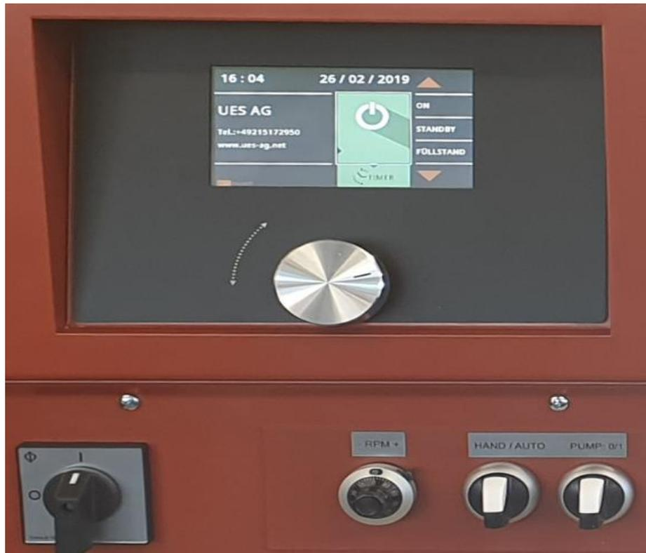
Unsere **exactaMelt** ist mit einem berührungssensitiven 4,3“-Farb-Touch-Display ausgestattet. Intuitiv werden Sie durch das Menü geführt. Wenn Sie eine Eingabe tätigen möchten, berühren Sie das Display an der gewünschten Stelle und geben über das Eingabefeld entsprechende Werte ein. Bestätigen Sie diese mit dem ENTER-Feld. Danach springt die Anzeige nach wenigen Sekunden automatisch zurück in das Übersichtsfeld. Hier werden Ihnen alle wichtigen Informationen während des Betriebes angezeigt.
