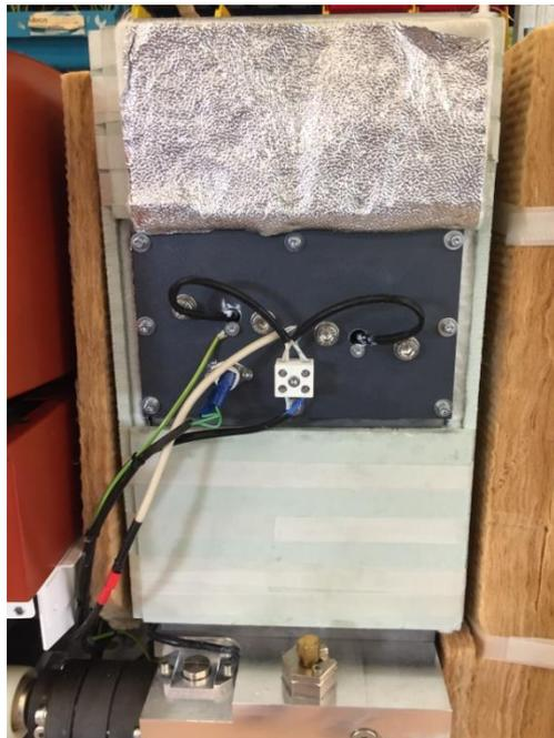
**Sensor Heizgrid (14 kg/20 kg/30kg) – „Tank2“ im Display – zugänglich von vorne - Bedienseite;
