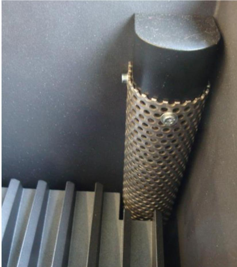
Füllstandsensoren im Tank
