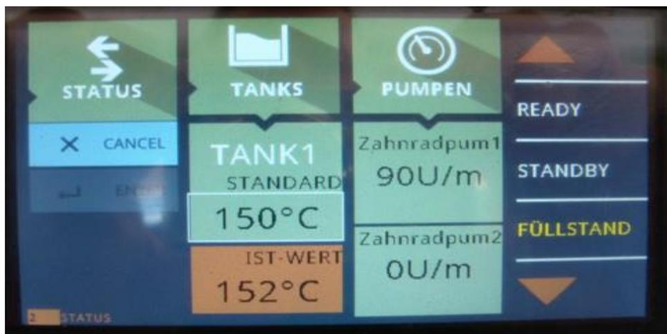
Alternativ verfügt die exactaMelt über ein Drehrad. Drehen Sie an dem Drehrad, bis die gewünschte Stelle im Menü hinterlegt ist. Durch Drücken des Rades wird dieses Feld aktiviert. Aktivieren Sie nun das Eingabefeld. Stellen Sie nun den gewünschten Wert über weiteres Drehen des Rades ein. Bestätigen Sie diesen Wert durch erneutes Drücken des Rades. Über diese beiden Methoden können Sie schnell, einfach und intuitiv Ihre Eingaben tätigen.
