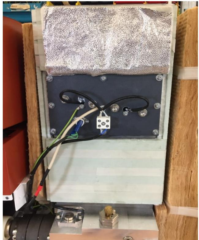
**Sensor Pumpe (4 kg/8 kg) oder Heizgrid (14 kg/20 kg/30 kg) – „Tank2“ im Display – zugänglich von vorne - Bedienseite; Kabel mit Stecker schaut aus der Isolierung hervor / Steckverbindung hinter der Frontklappe**
